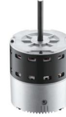
안재우 연구소장, 이원용 사업실장, 조철민 책임, 강정구 선임연구원이 개발한 고효율 정풍량 팬모터는 덕트형 냉난방기 내부의 팬에 사용되는 제어기 일체형 BLDC 모터(ECM)로, 별도의 풍량 센서나 압력 센서를 사용하지 않고도 필터나 덕트가 막히는 상황에서도 풍량을 일정하게 유지되도록 설계됐다. 팬 부하와 공기압의 변화에 따라 모터 속도를 자동으로 제어하여 성능 저하 없이 안정적인 냉방 및 난방이 가능하다.
