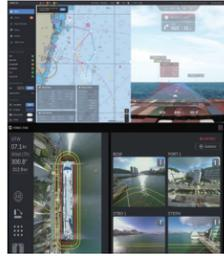
박진모, 이호진, 윤광욱 책임매니저가 개발한 HiNAS는 비전 기반의 탐지, 레이다, AIS 등 선박 기존 센서와의 융합을 통한 종합 상황 인지, 최적경로 안내 및 추종 제어, 자율 충돌회피 제어, 360도 실시간 주변 모니터링 기능을 갖춘 세계 최초/유일의 “인지-판단-제어”가 가능한 선박용 자율운항 시스템이다. 상용화 과정에서 필연적으로 수반되는 카메라 장비의 캘리브레이션 과정을 자동화해 타제품 대비 생산, 납품 과정에서 큰 효율성을 갖췄다.
