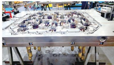
김진호 삼성전자 그룹장, 이영오 노바게이트테크놀로지 CTO, 황정호, 고대성 삼성전자 수석연구원이 개발한 금형 시스템은 플라스틱의 녹는 온도를 적절히 유지해 주는 핵심부품 핫 러너를 기존 상식을 뒤엎는 새로운 형태로 개발해 원가와 전력 소모량을 낮춰 대한민국 금형의 수출 경쟁력을 높였다. 낮은 전력 사용량으로 충분히 가열시켜 에너지 사용량을 절감하는 등 기존 금형에서 제공하지 못하던 에너지 사용량과 재활용 같은 ESG 영역에서의 부가가치를 갖췄다.
