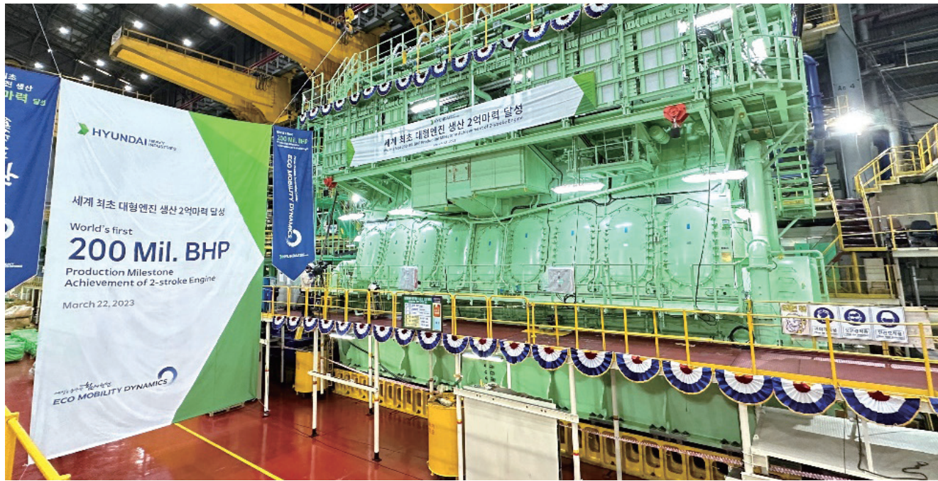
사진 3 HD현대중공업 2행정 메탄올 엔진(HD현대중공업에서 세계 최초 생산)
