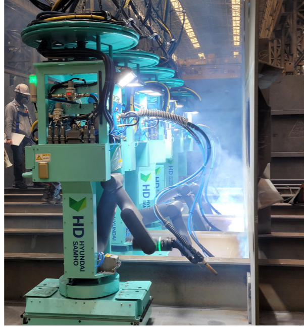
그림 2 뉴로메카의 용접 특화 협동로봇 옵티(Opti)
