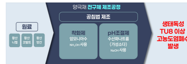
그림 1 양극재 전구체 제조 공정
