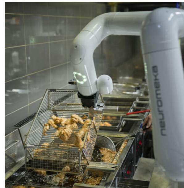
그림 3 뉴로메카가 교촌에프앤비와 협력하여 개발한 치킨 조리 자동화 로봇 Indy7
